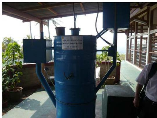
次の写真はインドネシアおよびベトナムでジャトロファ農園を開発している Waterland の子会社でバイオガス生産会社である VAN DER WIEL のバイオダイジェスターである。
