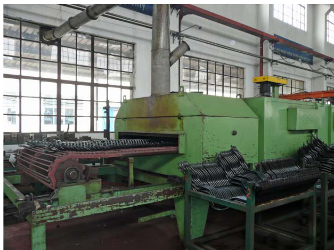
図 3.7 鋳造での低効率炉
