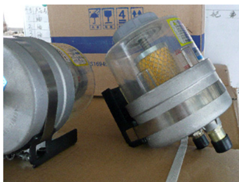
ポンプにつながるオイルタンク
