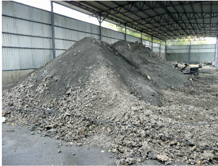
図 3.19 排煙を水に通して浄化した際に水中にたまったカス
