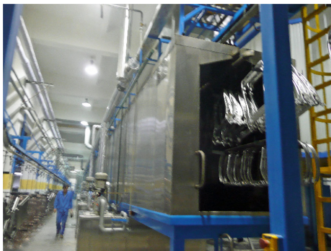
図 3.21 電気泳動ラインでの熱漏れ
