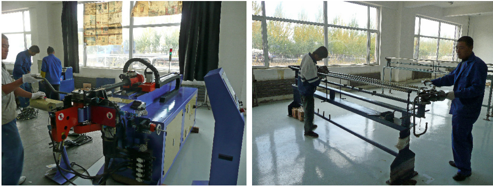
図 3.24 機械および人力によるオイルパイプの加工
