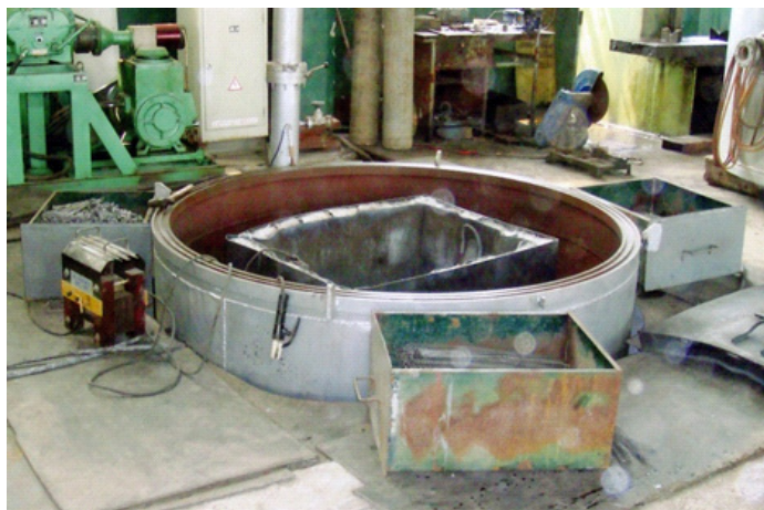
図 3.7 鋳造での低効率炉
