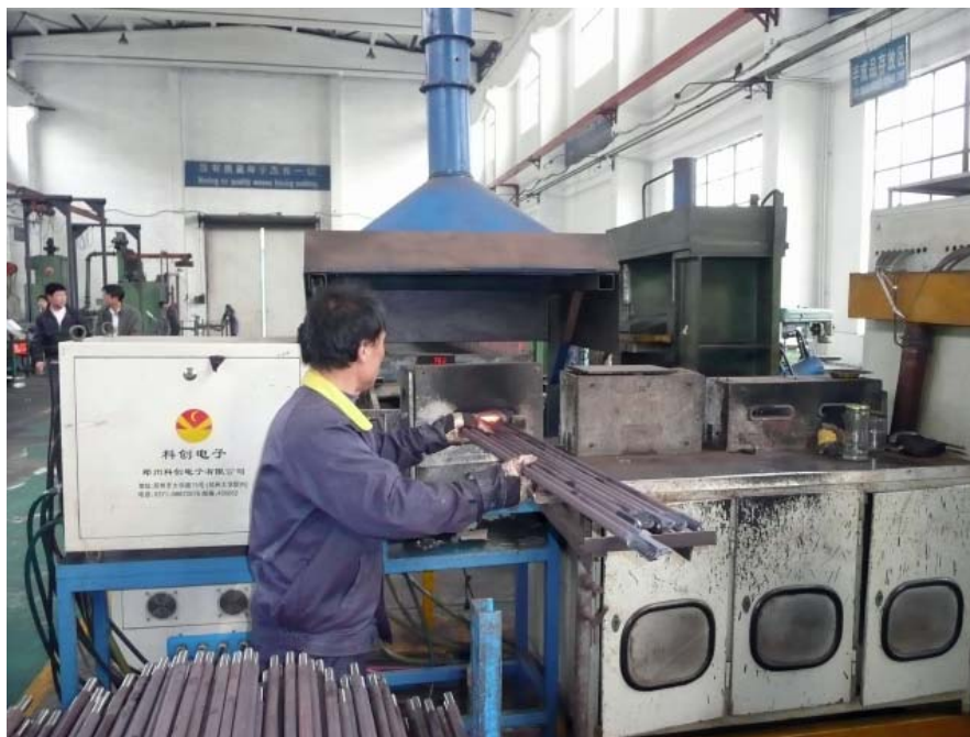
図 3-13 丸棒先端加熱用誘電炉
